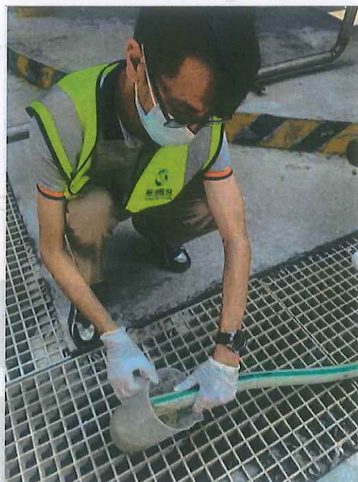
脱硫废水取水点
