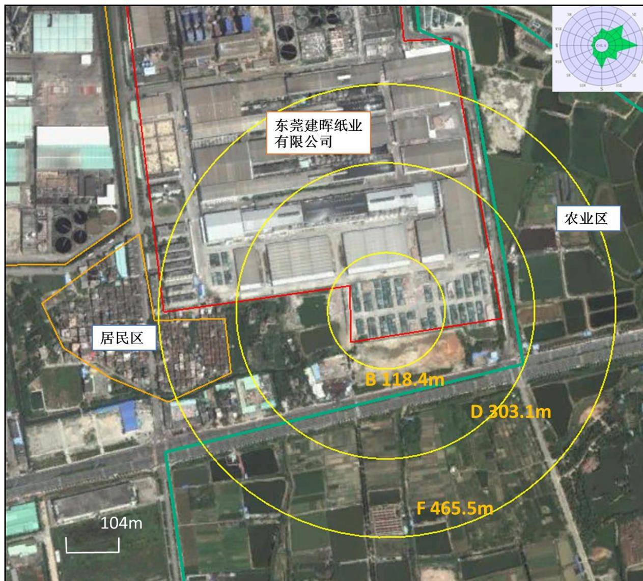
图 5-2 废纸堆场 CO 扩散等值线图（静风 PC-STEL）
