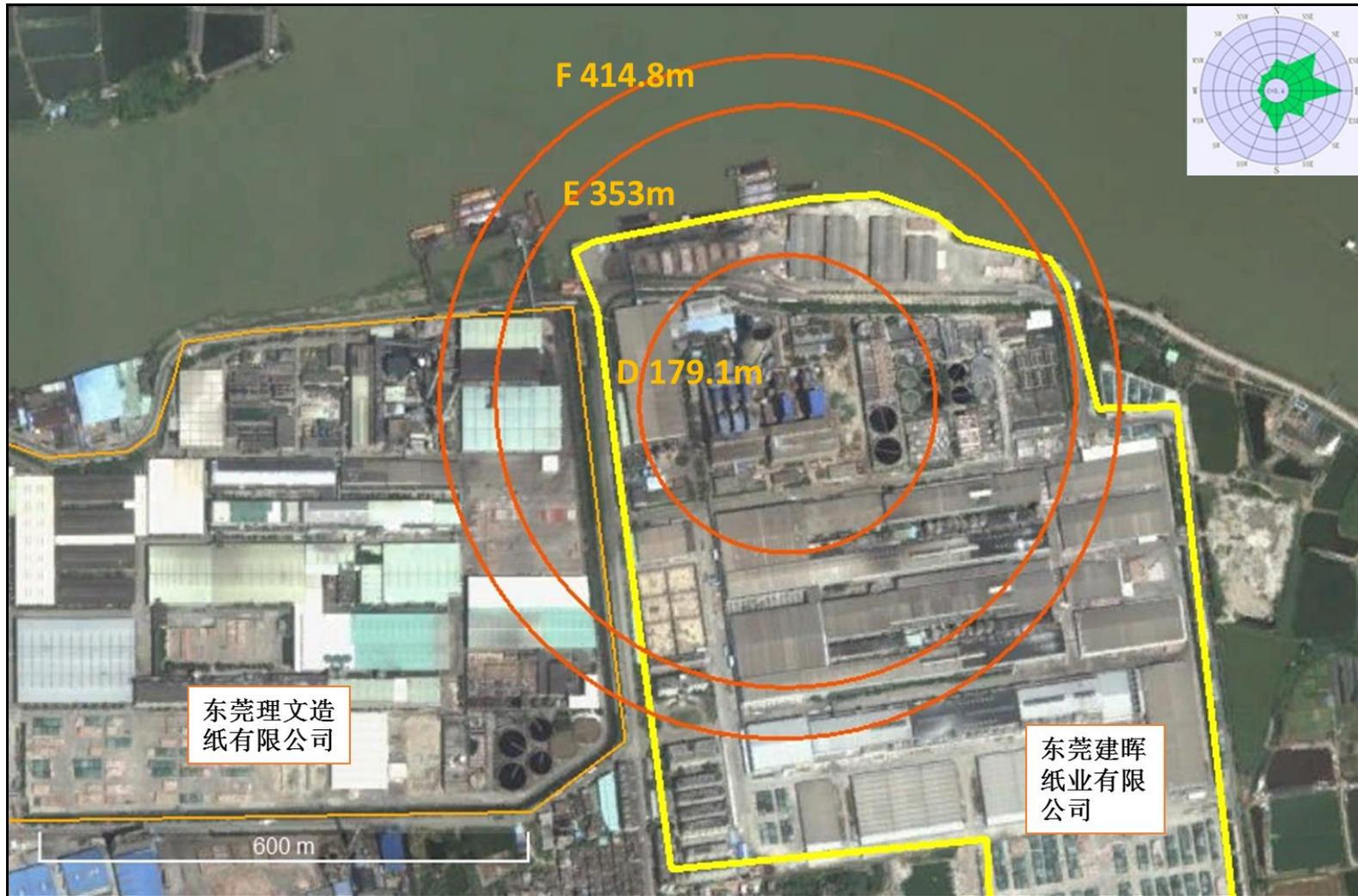
图 5-4 氨水储罐泄漏扩散等值线图（20%管径小风 PC-STEL）
